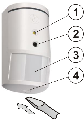
Obr.1: 1 – blesk (prisvietenie); 2 – objektiv kamery; 3 – sošovka PIR detektora; 4 – západka krytu;
