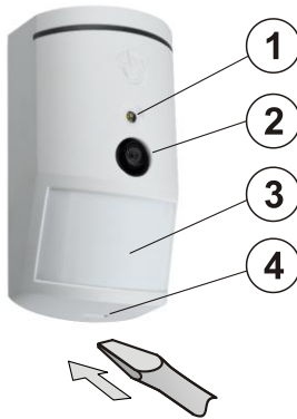
Obr.1: 1 – blesk pre osvetlenie priestoru; 2 – objektiv kamery; 3 – šošovka PIR detektora; 4 – západka krytu
